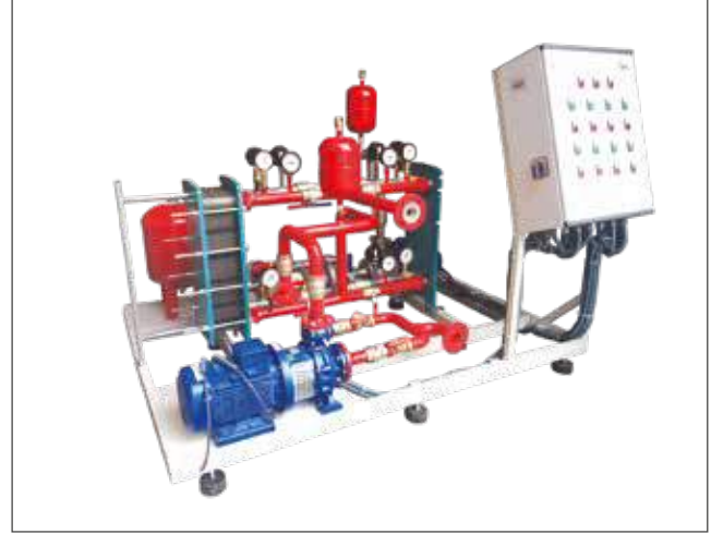
Çift eşanjörlü indüksiyon ocağı soğutma sistemidir.
